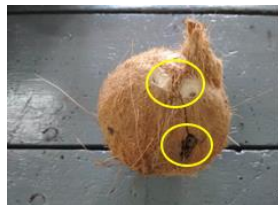
Gambar 10.22. Hasil pengupasan yang mengalami kepenggerusan batok
