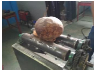
Gambar 10.20. Pengujian untuk panjang mata pisau 5 cm
