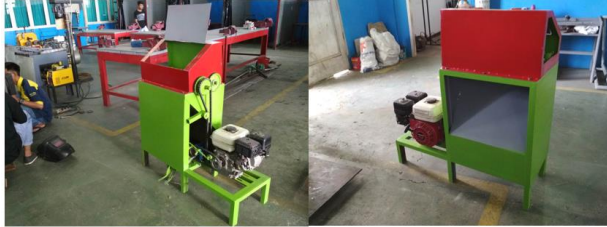
Gambar 10.19. Prototipe mesin pengupas sabut kelapa
