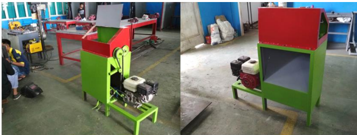
Gambar 9.16. Prototipe mesin pengupas sabut kelapa
