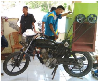
Gambar 10.6. Prototipe Pemipil Jagung
