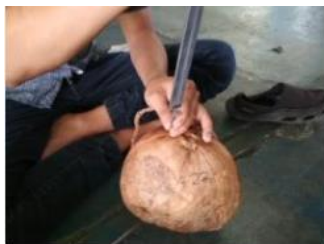
Gambar 4.12. Cara pengukuran tebal sabut kelapa
