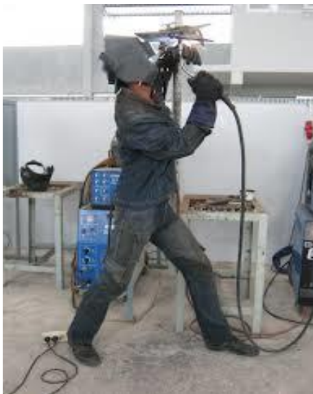
Gambar 8.15 Posisi Pengelasan Diatas Kepala
