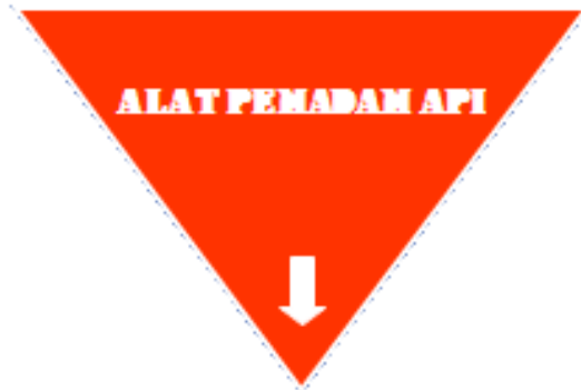
Gambar 7.12 Tanda Penempatan APAR Pada Dinding
