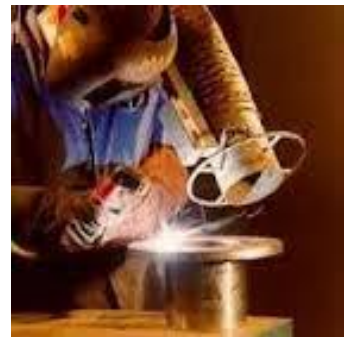
Gambar 8.13 Posisi Pengelasan Dibawah Tangan
