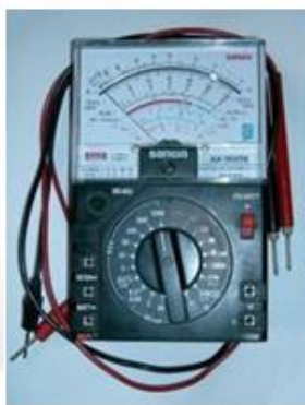
Gambar 5.8 Multi-meter analog menggunakan jarum penunjuk skala
